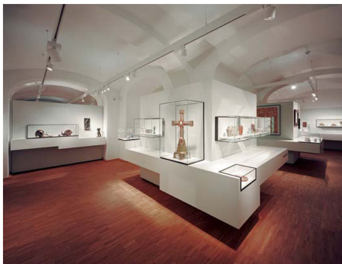
Abb.: Die Tisch-, Wand- und Pultvitrinen im Ausstellungsbereich Jugendstil werden durch externe Strahler beleuchtet.
