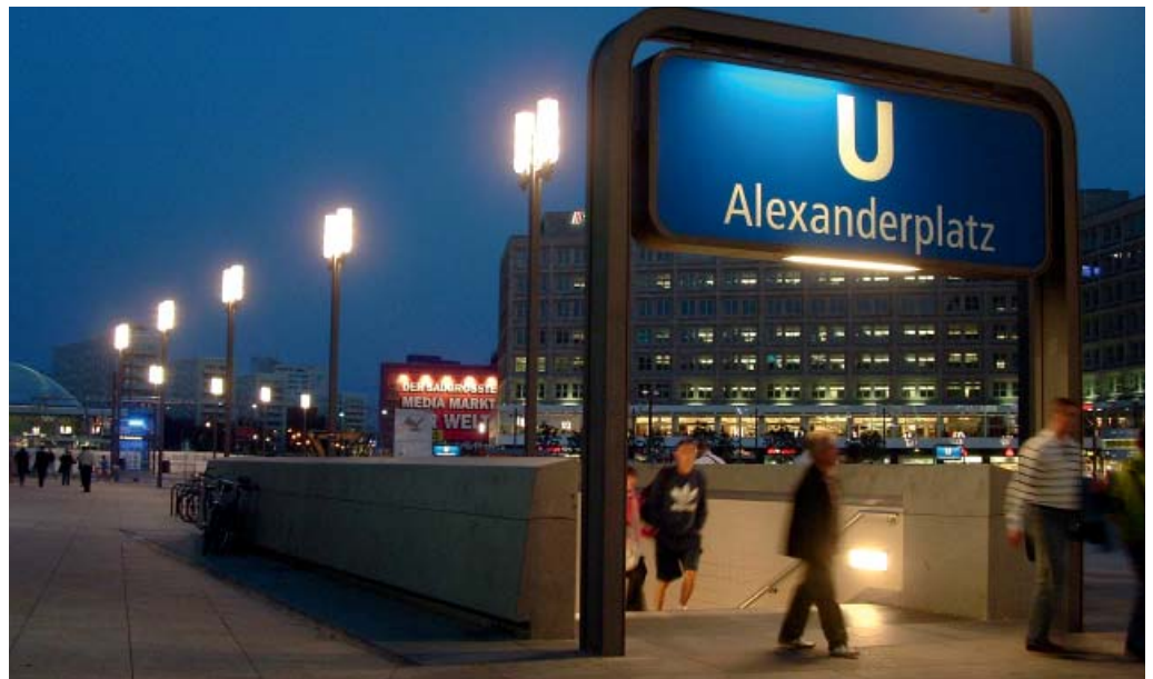
Die Leuchten zeichnen die polygonale Platzform nach und unterstützen die Proportionierung des Platzraumes. Ziel der Lichtplanung war das Sicherheitsgefühl zu erhöhen.
