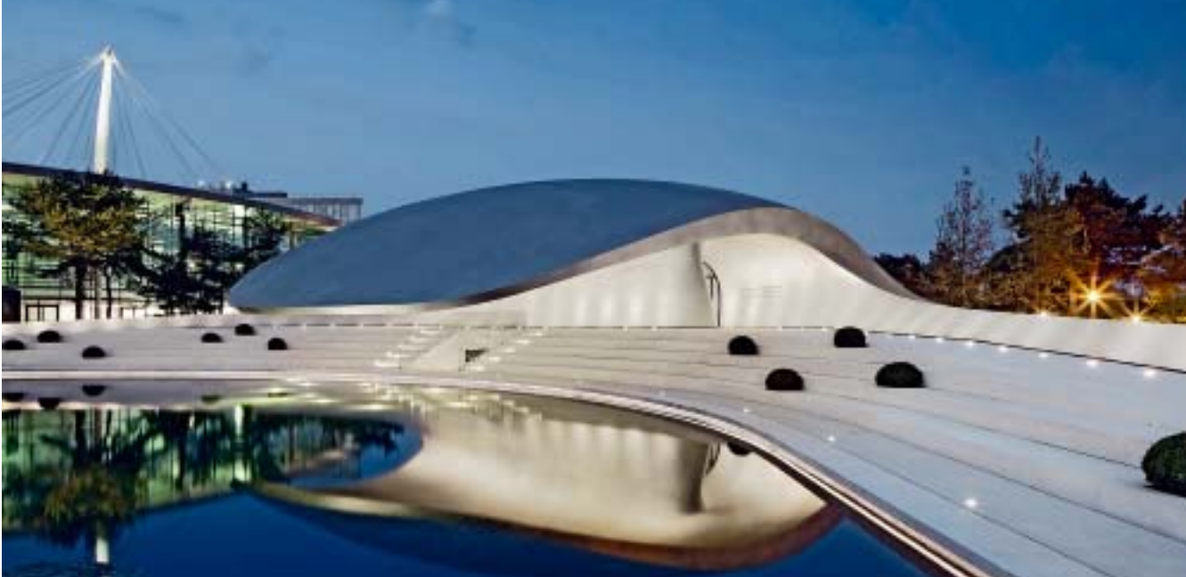
Bei Dunkelheit wird der Pavillon mitsamt umgebender Landschaft illuminiert in Szene gesetzt. Bei den hellen Stufen handelt es sich um Betonfertigteile aus Weißzement.
